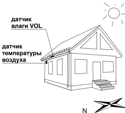
Рисунок 1. Размещение датчика температуры воздуха и датчика влаги
